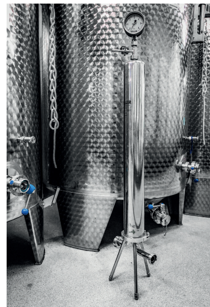
Filterkerzengehäuse: Leistung Abfüll-Filtration: 1000 l/h
