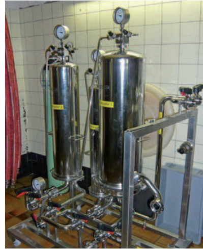
Filterpalette mit Spülwasserfilter: Leistung Abfüll- filtration: 4000 l/h
