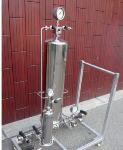
Filterpalette mit Spülwasserfilter: Leistung Abfüll- filtration: 2500 l/h
